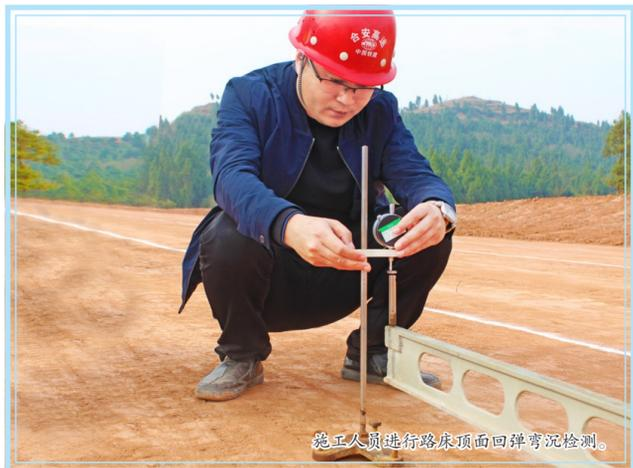
施工人员进行路床顶面回弹弯沉检测。
