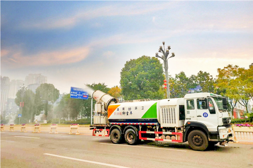
环卫车对城区实施降尘作业。
